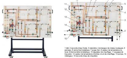
Une pompe de circulation assure la circulation à travers quatre radiateurs dont la température peut être ajustée par des vannes thermostatiques.
