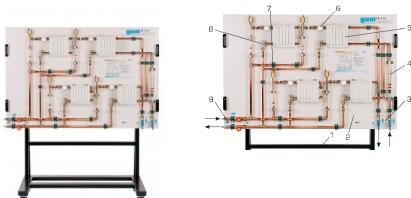
Le banc d'essai comprend un système de tuyauteries avec quatre radiateurs.
