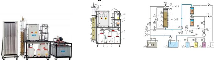
La filtration en profondeur à l'aide de filtres à sable et l'échange d'ions sont des opérations unitaires importantes du traitement de l'eau.
