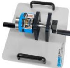
Ces modèles en coupe permettent d'expliquer de façon simple et précise le mode de fonctionnement des éléments constitutifs d'une machine, par exemple d'un embrayage à disques, de différents engrenages ou d'une chaise palier.
