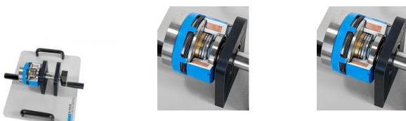
Ces modèles en coupe permettent d'expliquer de façon simple et précise le mode de fonctionnement des éléments constitutifs d'une machine, par exemple d'un embrayage à disques, de différents engrenages ou d'une chaise palier.
