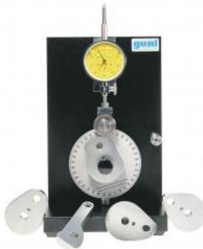
**GL 110 Démonstration et mesure de la courbe de levée de mécanismes à came (Réf. 030.11000)**
