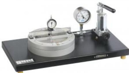
Pour l'analyse expérimentale des contraintes, on utilise des jauge de contrainte pour déterminer les contraintes présentes dans les composants et les constructions.
