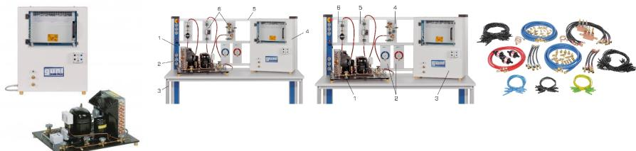
Il est possible de réaliser des expérimentations pratiques pour le fonctionnement d'une installation frigorifique par le maniement de circuits frigorifiques à compression configurés de différentes manières.
