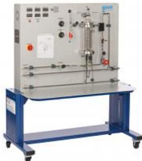
**ET 851 Turbine à vapeur axiale à un étage avec mesure de puissance (Réf. 061.85100)**
