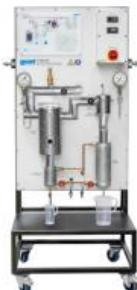
**ET 805.50 Détermination du titre de la vapeur avec calorimètre à séparation (Réf. 061.80550)**
