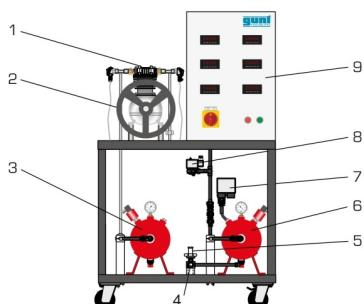
1 compresseur, 2 poulie de courroie, 3 réservoir d'aspiration, 4 soupape de purge avec silencieux, 5 soupape de sécurité, 6 réservoir sous pression, 7 pressostat, 8 électrovanne, 9 armoire de commande avec affichages numériques
