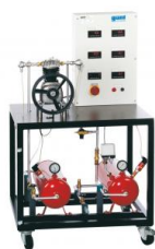
1 compresseur, 2 probe de courant, 3 réservoir d'aspiration, 4 soupape de purge avec sélecteur, 5 soupape de sécurité, 6 réservoir auxiliaire, 7 pression, 8 électrovanne, 9 armature de commande avec affichage numérique
