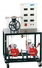
1 compresseur, 2 poulie de courroie, 3 réservoir d'aspiration, 4 soupape de purge avec sélecteur, 5 soupape de sécurité, 6 réservoir auxiliaire, 7 pression, 8 électrovanne, 9 armature de commande avec affichage numérique
