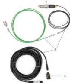
Pour les essais avec indication de pression dans le cylindre sur le moteur de test CT 300.04, la bougie normale est remplacée par une bougie instrumentée.
