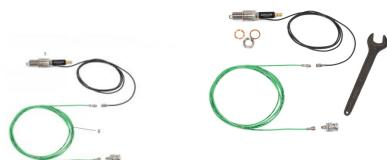
Pour les essais avec indication de pression dans le cylindre sur le moteur de test CT 100.21, la bougie normale est remplacée par une bougie instrumentée.
