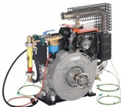
En combinaison avec le banc dessai CT 110, qui renferme une unité de freinage et dentraînement, le moteur diesel quatre temps convient parfaitement à lenseignement des principes de base du fonctionnement et de la technique de mesure sur moteurs.
