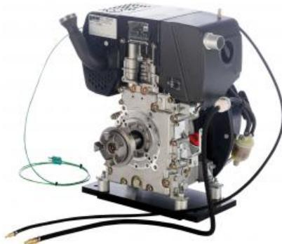
En combinaison avec le banc dessai CT 110, qui renferme une unité de freinage et d entraînement, le moteur diesel quatre temps convient parfaitement à lenseignement des principes de base du fonctionnement et de la technique de mesure sur moteurs.
