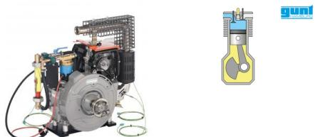
En combinaison avec le banc dessai CT 110, qui renferme une unité de freinage et d entraînement, le moteur diesel quatre temps convient parfaitement à lenseignement des principes de base du fonctionnement et de la technique de mesure sur moteurs.
