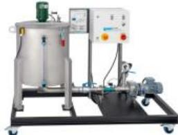
Le CE 285 alimente les bancs d'essai de filtration en suspension de diatomite et d'eau (recommandée). Elle est préparée dans le réservoir de mélange.
