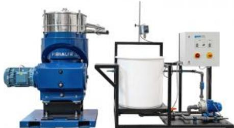
Une centrifugeuse à plateaux permet de séparer des mélanges de liquides non miscibles entre-eux.
