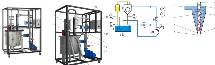
Les hydrocyclones permettent de séparer les matières solides en suspension dans un liquide. Dans le cas du CE 225, la suspension est préparée dans un réservoir.
