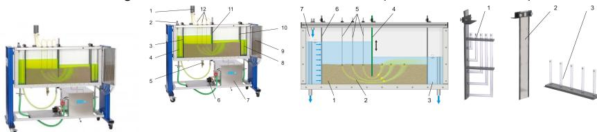
La visualisation des lignes de courant et leur représentation graphique sous la forme d'un réseau d'écoulement constituent une méthode explicite d'étude de l'écoulement d'infiltration et de l'écoulement souterrain.
