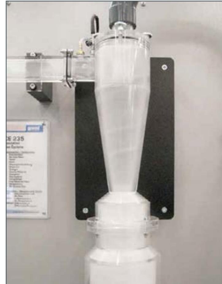
Séparation de particules fines de quartz dans le cyclone gaz pendant un test de fonctionnement dans notre laboratoire. On reconnaît le mouvement en forme de spirale des particules qui est caractéristique des cyclones.
