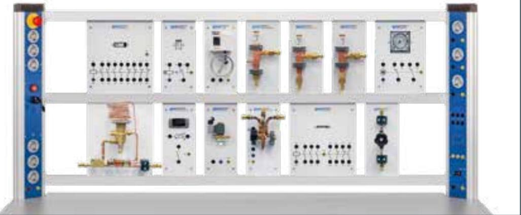
Essais supplémentaires avec des régulateurs primaires et secondaires dans le circuit frigorifique. Des composants électriques permettent également de réaliser des tâches du domaine de l'électrotechnique.
