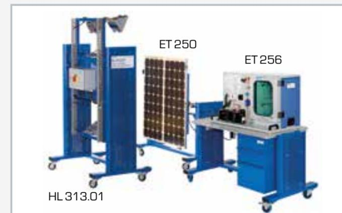
ET 256 avec la source de lumière artificielle optionnelle HL 313.01 et les modules solaires ET 250
