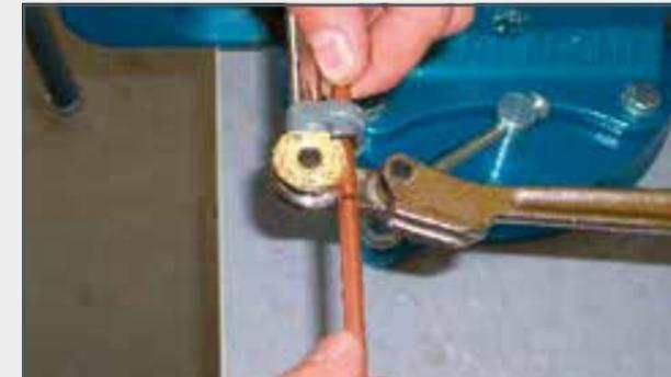
Insérer le tube dans le dispositif de pliage
