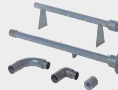
**HM 240.05 Pertes de charge dans des éléments de tuyauterie**
