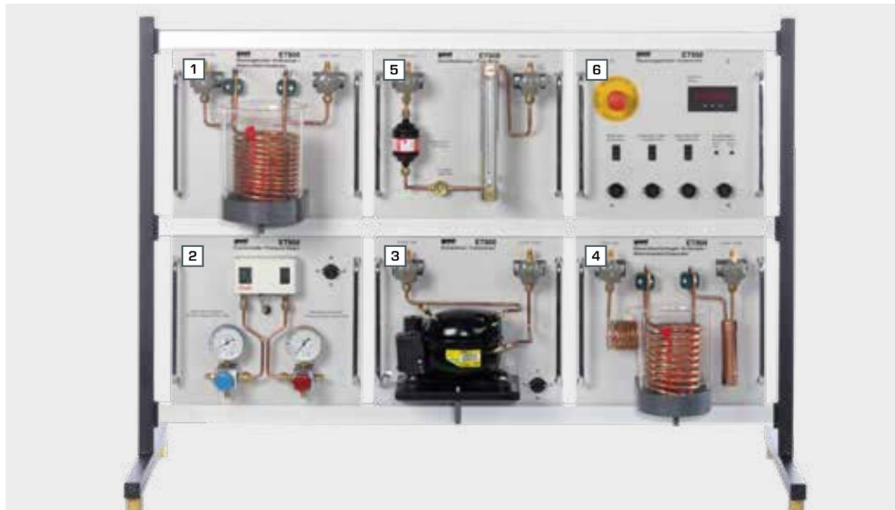
Circuit frigorifique avec condenseur refroidi par eau et évaporateur chauffé par eau
