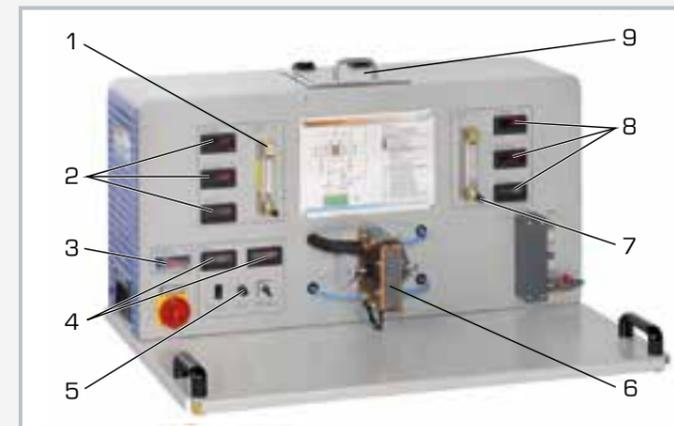
1 débitmètre d'eau froide, 2 affichages de température du côté froid, 3 régulateur de température du réservoir d'eau, 4 affichages de tension et courant, 5 ajustage de la puissance électrique, 6 élément Peltier avec des échangeurs de chaleur, 7 débitmètre d'eau chaude, 8 affichages de température du côté chaud, 9 couvercle de réservoir d'eau
