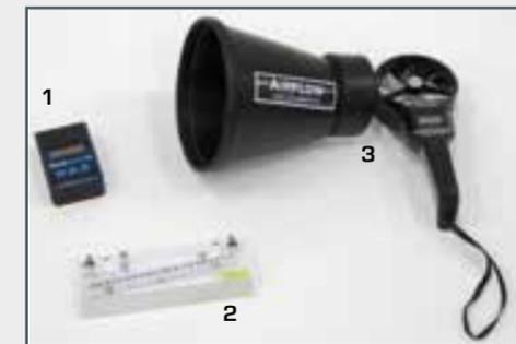
1 manomètre numérique, 2 manomètre de tube incliné, 3 anémomètre
