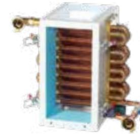
Les échangeurs de chaleur avec **tubes à ailettes** sont utilisés pour obtenir un transfert de chaleur optimal entre des fluides gazeux et des liquides, à condition que les fluides ne soient pas souillés. Cet **échangeur de chaleur air-eau** est inséré dans le conduit d'air du WL 312 dans lequel il est fixé à l'aide de fermetures à genouillère. Le raccordement à l'alimentation en eau chaude et en eau froide est assuré par des flexibles avec accouplements rapides.
