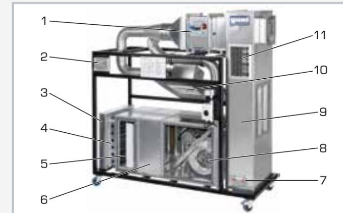
1 clapet coupe-feu, 2 manomètre à tube incliné, 3 grille de protection contre les intempéries, 4 persienne, 5 filtre, 6 échangeur de chaleur, 7 couvercle de révision, 8 ventilateur avec moteur d'entraînement, 9 conduit d'air, 10 bouche de ventilation du plafond, 11 bouche de ventilation murale
