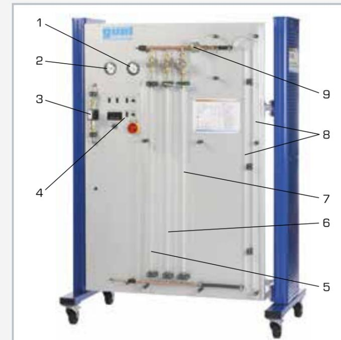
1 manomètre côté pression, 2 manomètre côté aspiration, 3 débitmètre, 4 éléments d'affichage et de commande, 5 conduite montante Ø 6mm, 6 conduite montante Ø 10mm, 7 conduite montante Ø 14,4mm, 8 conduite montante double, 10 vanne de choix de la conduite montante
