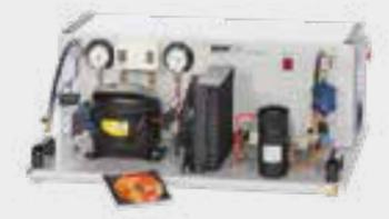
ET 915 avec les modèles de réfrigérateur et d'installation frigorifique pour expliquer le fonctionnement des systèmes de refroidissement
