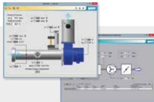
Le logiciel GUNT montre les valeurs mesurées sur PC d'une manière claire et permet de procéder à une évaluation aisée. Différentes fonctions permettent de procéder à un enregistrement graphique des valeurs mesurées et à la sauvegarde des résultats.
