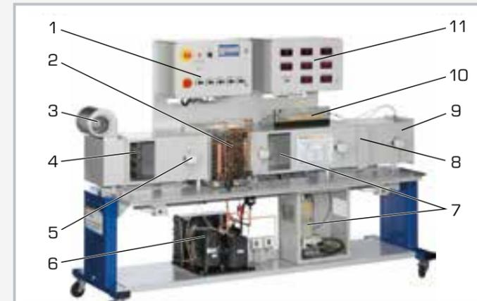
1 éléments de commande, 2 refroidisseur d'air (évaporateur direct), 3 ventilateur, 4 préchauffeur d'air, 5 capteur de température, 6 groupe frigorifique, 7 humidificateur d'air, 8 réchauffeur d'air, 9 conduit d'air, 10 manomètre à tube incliné, 11 éléments d'affichage
