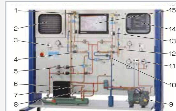
1 soupape de détente, 2 chambre de congélation, 3 thermostat, 4 échangeur de chaleur, 5 électrovanne, 6 condenseur, 7 régulateur de pression de condensation, 8 régulateur de puissance, 9 compresseur, 10 régulateur de démarrage, 11 pressostat, 12 régulateur de pression de l'évaporation, 13 débitmètre, 14 chambre de refroidissement, 15 PC à écran tactile
