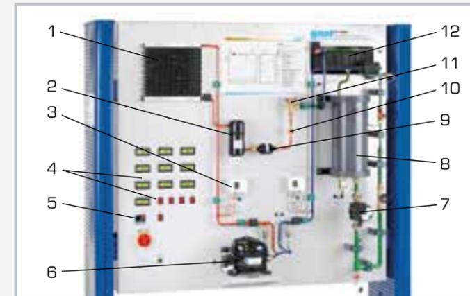
1 condenseur avec ventilateur, 2 réservoir, 3 pressostat de haute pression, 4 éléments d'affichage et de commande, 5 régulateur pour dispositif de chauffage, 6 compresseur, 7 pompe, 8 réservoir d'eau avec dispositif de chauffage, 9 filtre/sécheur, 10 voyant, 11 soupape de détente, 12 évaporateur
