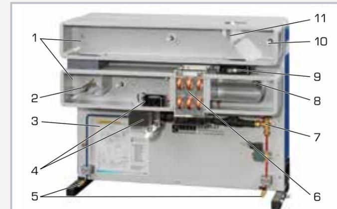
1 conduit d'air, 2 réchauffeur d'air, 3 schéma de processus, 4 humidificateur d'air, 5 raccords à l'ET 915, 6 évaporateur, 7 soupape de détente, 8 préchauffeur d'air, 9 ventilateur, 10 capteur d'humidité et de température, 11 volet de ventilation
