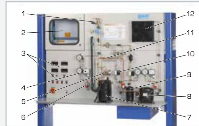
1 soupape de détente, 2 chambre de refroidissement, 3 éléments d'affichage et de commande, 4 pressostat, 5 injecteur, 6 injecteur de refroidissement, 7 compresseur BP, 8 compresseur HP, 9 réservoir, 10 débitmètre, 11 échangeur de chaleur, 12 condenseur
