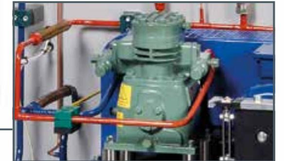
Le **compresseur** est l'unité motrice d'un système frigorifique à compression. Il extrait le réfrigérant gazeux de l'évaporateur, augmente sa pression et le transporte dans le condenseur. Le compresseur doit augmenter la pression du réfrigérant gazeux pour qu'il puisse se condenser dans le condenseur, libérant de la chaleur.
