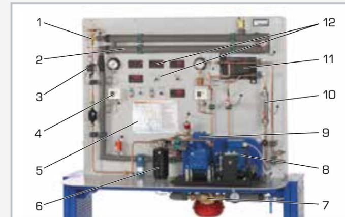
1 soupape de détente, 2 évaporateur, 3 débitmètre agent réfrigérant, 4 pressostat, 5 schéma de processus, 6 réservoir, 7 circuit d'eau chaude de l'évaporateur, 8 moteur d'entraînement, 9 compresseur, 10 débitmètre eau de refroidissement, 11 condenseur, 12 éléments d'affichage et de commande
