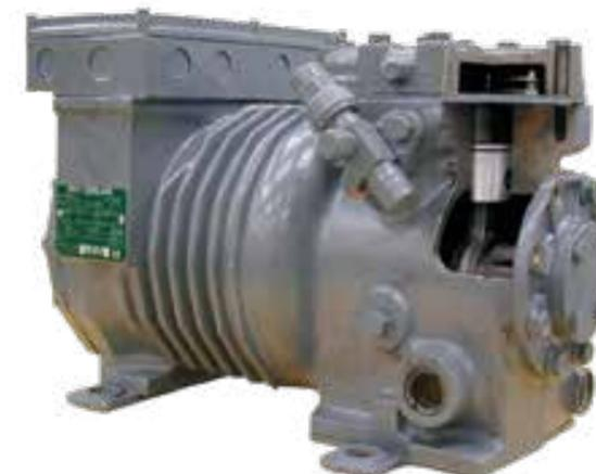
**ET 499.03**Modèle en coupe: compresseur d'agent réfrigérant
