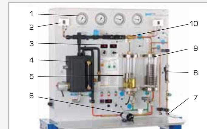
1 manomètre, 2 pressostat, 3 éléments d'affichage et de commande, 4 générateur de vapeur, 5 évaporateur, 6 pompe, 7 raccords d'eau de refroidissement, 8 débitmètre, 9 condenseur, 10 compresseur à jet de vapeur
