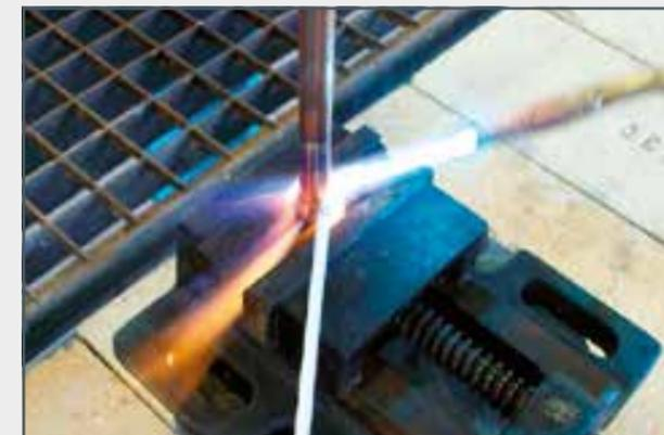
Réchauffer la pièce à usiner jusqu'à obtenir la chaleur de soudage et la fonte du fondant et de la soudure. Par effet de capillarité, la soudure remplit d'elle-même l'interstice de soudage.
