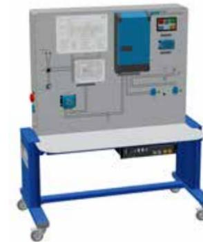
**HM 143****Processus d'écoulement non stationnaires dans les réservoirs**
