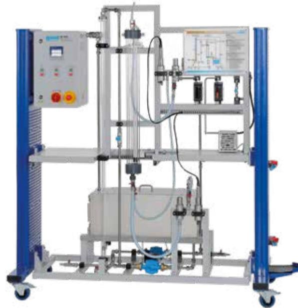
**CE 540****Séchage de l'air par adsorption**
