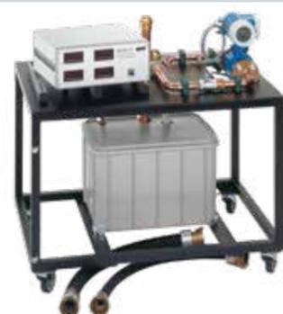
**HM 332****Caractéristiques de pompes montées en parallèle et en série**
