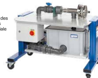
**HM 405****Installation d'essai de turbomachines axiales**
